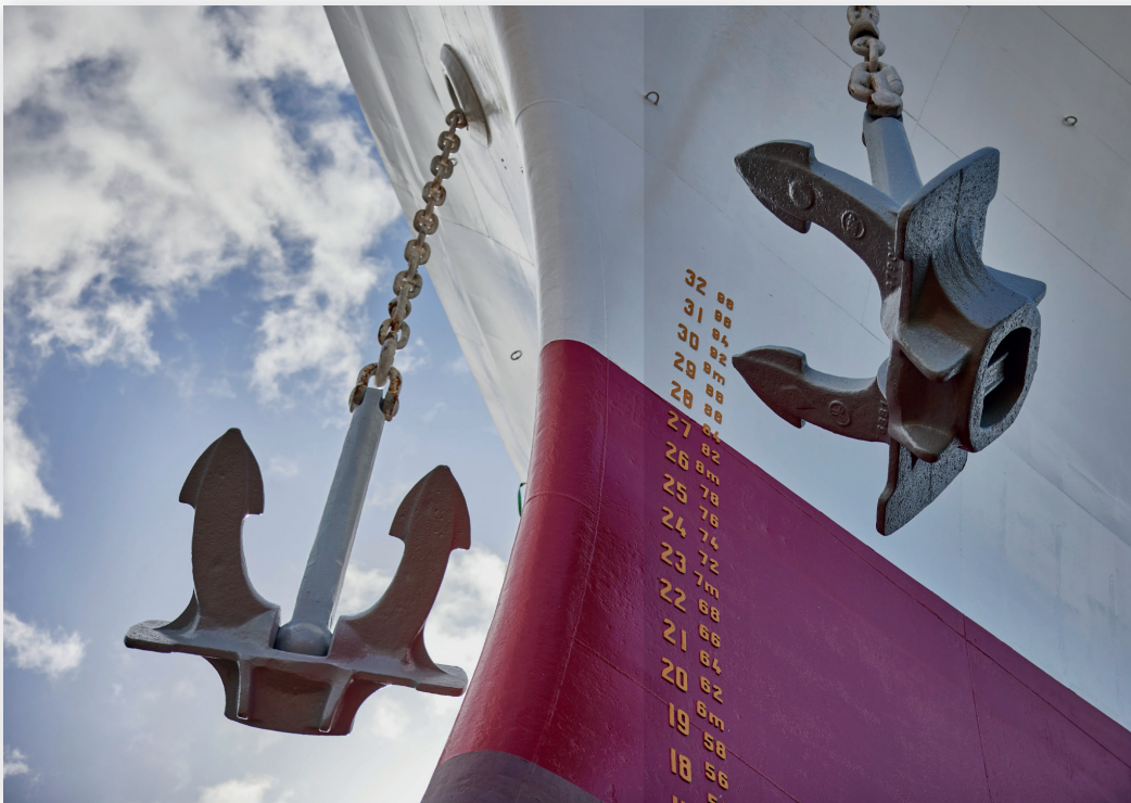
Die beiden Patentanker mit ihren imposanten Flanken werden eingeholt. Jeder wiegt 4,8 Tonnen.
