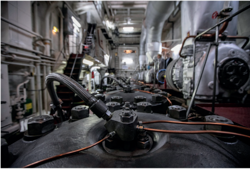
Die Zylinderseite der Hauptmaschine: Durch die gepanzerten Rohre gelangt der Brennstoff zu den Einspritzdüsen
