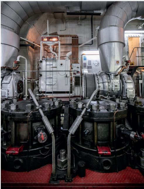
Während der Fahrt unter Hochdruck: Zwei Zylinderdeckel und zwei der drei Abgas-Turbolader
